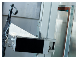
Buse de rotation à entraînement électrique
