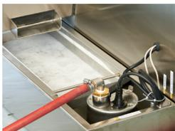
Bomba de filtración y de las aguas de evacuación
