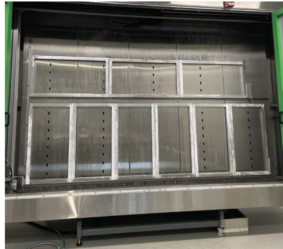
In der Wasserstrahlanlage G-Prep 370 wird der Schablonenkleber verschleißfrei von den Rahmen entfernt.
